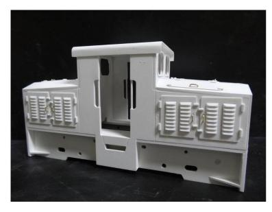
In die Laternen setzen Sie die beiden Glühlämpchen ein und kleben vorne die Glasscheibe (38) ein. Dann kommen die beiden Lampen an die beiden Führerhaus wände. Kleben Sie nun noch die Glasscheiben (39) in die Fenster und das Firmenschild (40) auf den Lüfter. Das Gehäuse ist nun fertig.
