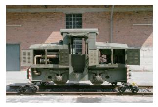
Vorbauten: Die Lok hat zwei verschiedene Vorbauten: In dem einen Teil ist der Motor untergebracht, auf der anderen Seite der Tank. Die Oberseite des Motorvorbaus hat die drei rechts abgebildeten Seiten mit den Klappen, auf der Tankseite gibt es nur oben in der Mitte eine Klappe und den Tankstutzen.
