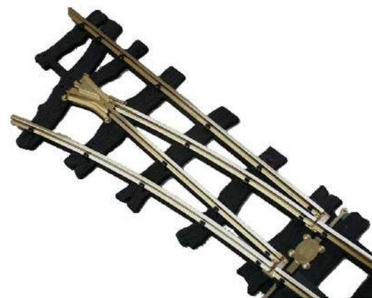
Nun folgt das gerade Außenprofil mit einer Länge von 300 mm. Ebenfalls alle Kanten brechen und in der Gleiterplatte einpassen, Schienenstühle aufschieben und einpassen, jetzt lässt sich die M2x10 Schraube mit den Federscheiben richtig in der Gleiterplatte befestigen, ebenso an der Unterseite des Schwellenbettes die Kontaktstange mit einer M2 Mutter befestigen. Diesen eben beschriebenen Vorgang nehmen Sie bitte ebenso bei der gebogenen Außenschiene vor, Gleisprofillänge 245 mm.
