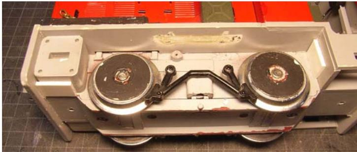
Anschließend kleben Sie den Aussenrahmen ein. Die Verstärkungsdreiecke werden vorne horizontal gegen die Pufferbohle und oben in der Mitte vertikal unter den Umlauf geklebt.
