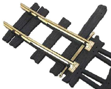
Biegen Sie die Spurstellstange etwas nach oben durch, sodass eine Andruckspannung entsteht. Schrauben Sie probehalber das Messingschild mit vier M2x8 Schrauben fest. Achten Sie bitte darauf, dass die lange Stellstange durch das Messingschild leicht angedrückt wird, um immer einen Schleifkontakt in den Gleiterplatten zu haben.
